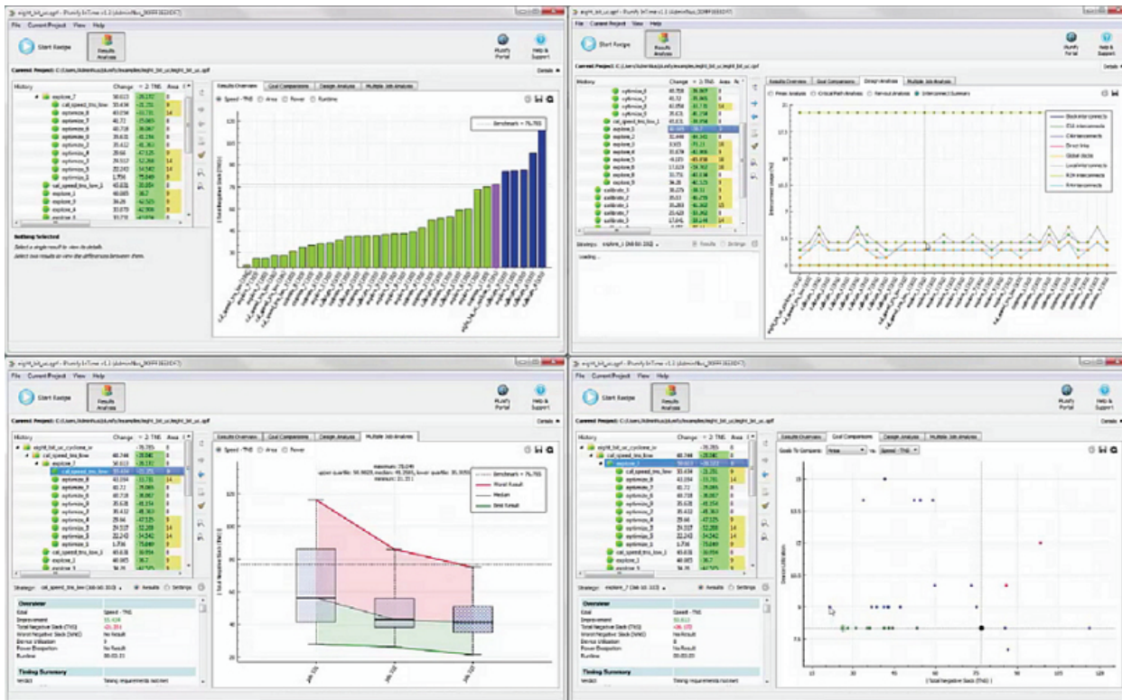
図3: 異なるコンパイルのTNS、インターコネクトチャート、機械学習進捗、TNS/WS分布（左上から時計回り）
